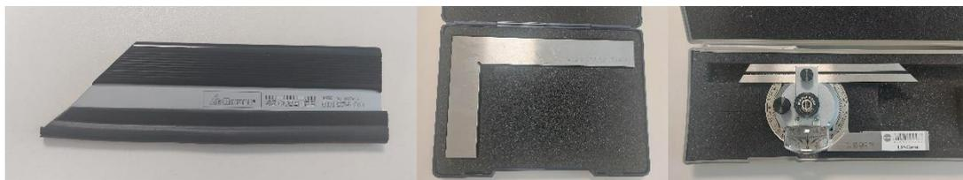
Abbildung 1: Kalibriergegenstände von Links nach Rechts: 1) Haarlineal, 2) Flachwinkel, 3) Universalwinkelmesser mit Lupe
