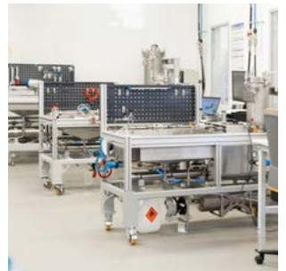
In verschiedenen Branchen bestimmen Durchflussmessungen von Flüssigkeiten unmittelbar den Produktionsbetrieb und die Qualität. Testo Industrial Services verfügt über eigens konzipierte Prüfstände, die eine Kalibrierung von Durchflussmessern für Flüssigkeiten von 0,15 ml/min bis 5.000 l/min ermöglichen. Neben Wasser kann die Kalibrierung beispielsweise auch mit Alkohol oder verschiedenen Ölen erfolgen.
