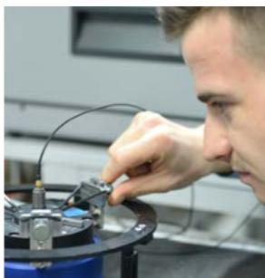
Unser Kalibrierservice umfasst Beschleunigungssensoren, Vibrationsmessgeräte und Signalkonditionierer. Hierbei bieten wir herstellerunabhängige DAkkS-akkreditierte Kalibrierungen an. Ebenfalls ist die Kalibrierung individueller Lösungen von kontaktlosen Schwingungsfrequenzzählern oder Vibro-Pads möglich. Kalibriert wird nach dem Prinzip der sekundären Vergleichskalibrierung gemäß DKD-R 3-1 ISO 16063-21.
