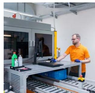
Unser Labor verfügt über einen vollautomatisierten Messroboter, welcher innerhalb kürzester Zeit Messschieber mit sehr geringen Messunsicherheiten für Sie kalibriert. Neben dem normativen Kalibrierumfang wie Außen-, Innen-, Tiefen- und Stufenmessungen, werden auch die Lichtspaltprüfungen und Leichtgängigkeitsprüfungen mit dem Kalibriroboter vollautomatisiert bis zu einem Messbereich von 300 mm durchgeführt.
