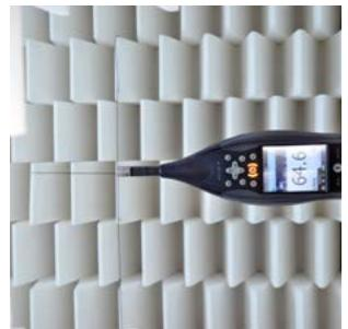
Die Freifeldkalibrierung ist von 125 Hz bis 20 kHz in Terz- bzw. Oktavschritten möglich. Sie ist speziell für die Kalibrierung von Freifeldmikrofonen und Schallpegelmessgeräten nach DIN EN 61094-8 und DIN EN 61672-3 geeignet. Die Bewertungen erfolgen nach der DIN EN 61094-4 sowie nach der DIN EN 61672-1 und die Frequenzbewertung nach Z, A, C für Schallpegelmessgeräte.
