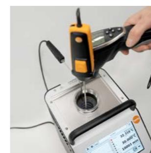
Um eigenständige Temperaturkalibrierungen oder -überprüfungen durchzuführen, sind Blockkalibratoren oder auch Umwälzthermostate geeignete Messeinrichtungen. Hierfür bieten wir Ihnen die passende Kalibrierung an: Wir kalibrieren Ihre portablen Temperaturkalibratoren (Blockkalibratoren) sowie Ihre Kalibrierbäder bzw. Umwälz-/Überlauf-Thermostate in einem Messbereich zwischen -100 °C und 1.000 °C in unserem Labor oder direkt bei Ihnen vor Ort.
