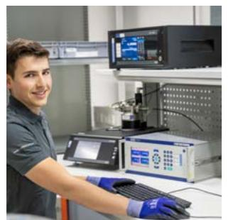
In unserem DAkkS-akkreditierten Labor können Druckmessgeräte wie zum Beispiel Druckcontroller, elektrische Bezugsnormale sowie Handmessmittel kalibriert werden. Unsere Kalibrierleistungen umfassen derzeit Kalibrierungen von -1 bar bis 250 bar bei geringsten Messunsicherheiten.
