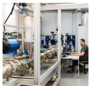
Testo Industrial Services hat den Messbereich von Durchflussmessern erweitert. Mit dem eigens konstruierten Prüfstand können ISO-/Werkskalibrierungen sowie DAkkS-akkreditierte Kalibrierungen von Durchflussmessern für Wasser von 25 l/min bis zu 5.000 l/min bei einer Messunsicherheit bis zu  $\pm 0,1$  % vom Messwert durchgeführt werden. Bei der Kalibrierung nach dem Master-Meter-Vergleichsverfahren wird mittels mehrerer parallel geschalteter Pumpen Wasser in die Umlaufstrecke befördert.
