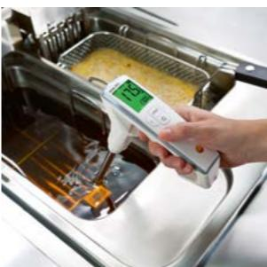
Frittieröltester dienen der Qualitätssicherung (Ermittlung des Verschmutzungsgrades) von Frittieröl. Ein Frittieröltester misst den Anteil der so genannten „Total Polar Materials“ (TPM) im Öl und gibt diesen in Prozent an. Messgeräte zur Messung des TPM-Wertes können bei 4 % TPM sowie 24 % TPM kalibriert werden.
