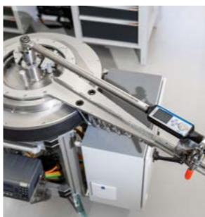
Mit Hilfe unseres Drehwinkelprüfstandes sind wir für die Kalibrierung Ihrer Drehwinkelsensoren und Messsysteme sowie Drehmoment- und Drehwinkelschlüssel nach VDI/VDE 2648 Blatt 1: 2024-05 ideal ausgestattet. Für Ihre Drehwinkelgeber können wir kombinierte DAkkS-akkreditierte Kalibrierungen mit einer Drehgeschwindigkeit von < 0,2 1/min durchführen.
