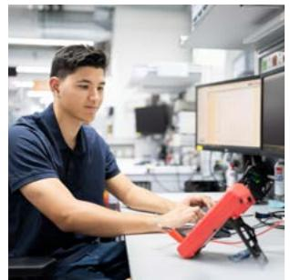
Im Niederfrequenz-Labor werden verschiedene elektrische Messgeräte der Gleich- und Wechselstromtechnik mit geringsten Messunsicherheiten kalibriert. Die Kalibrierung von Leistungsmessgeräten erfolgt im direkten Messverfahren über drei eigens dafür eingerichtete Kalibrator-Messplätze. Die Rückführung dieser Messplätze erfolgt in unserem hauseigenen Referenzlabor.
