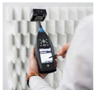
Die akustische Kalibrierung von Klasse 1 und Klasse 2 Kalibratoren und Pistonfonen können im Kalibrierlabor von Testo Industrial Services durchgeführt werden. Nach dem Substitutionsverfahren wird die Kalibrierung an Festpunkten des Kalibiergegenstandes bei 250 Hz bzw. 1.000 Hz bei einer Messspanne von 70 bis 130 dB durchgeführt und speziell nach den Anforderungen der DIN EN IEC 60942 konzipiert.
