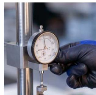
In unseren Laboren werden bei einer konstanten Temperatur von  $20^{\circ}\text{C} \pm 1\text{ K}$  nahezu alle Arten von anzeigenden Längenmessmitteln kalibriert.
