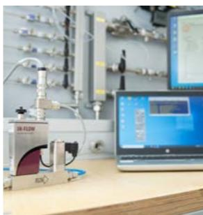
Die Bestimmung von Durchfluss für Luft und Inertgase spielt in vielen Industriebranchen eine entscheidende Rolle und wird oft unmittelbar für qualitätssichernde Maßnahmen eingesetzt. Mit unseren Prüfständen ermöglichen wir unter anderem die Kalibrierung von Durchflussmessern für Gase sowie für Durchflussmesser mit einer starken Druckabhängigkeit.
