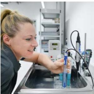
pH-Messgeräte können mit Lösungen bei 2 pH, 4 pH, 7 pH, 9 pH, 10 pH und 11 pH kalibriert werden. Kalibrierungen für Messgeräte zur Messung der Leitfähigkeit sind zwischen 1,3 µS/cm, 5 µS/cm, 15 µS/cm, 100 µS/cm, 706 µS/cm, 1413 µS/cm oder 5 mS/cm, 12,88 mS/cm, 50 mS/cm und 100 mS/cm möglich.
