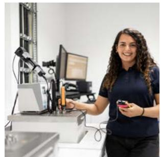
Bei geringsten Messunsicherheiten kalibrieren wir in einem Bereich von -196 °C bis +1.200 °C. Alle elektronischen Temperaturmessgeräte, Widerstandsthermometer und Thermoelemente werden im Flüssigkeitsbecken oder im Rohrofen mit einem Natrium-Wärmerohr sowie in unseren modernen Temperaturschränken kalibriert.
