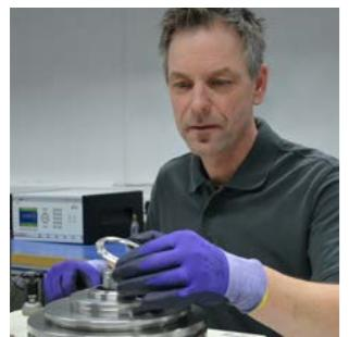
In unseren Laboren können wir für Sie DAkkS-akkreditierte Kalibrierungen bis zu einem Druck von 1.200 bar anbieten. Zusätzlich können Werkkalibrierungen mit einem Druck von bis zu 5.000 bar durchgeführt werden. Unser Labor beruht auf zwei unterschiedlichen Referenzarten: Druckwaagen und Druckregler. Zusätzlich besteht die Möglichkeit, anwendungsbezogen die Druckkalibrierung Ihrer Sensoren bei unterschiedlichen Temperaturen (-30 °C bis 120 °C) durchzuführen.
