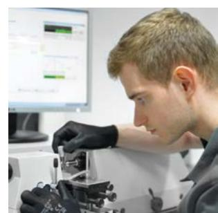
Mehrere horizontale Längenmessgeräte mit einer maximalen Länge von bis zu 1.000 mm für Außenmessungen bzw. bis zu 800 mm für Innenmessungen und Gewindemessscanner, werden im dimensionellen Labor von Testo Industrial Services als Referenzmessseinrichtung bei der Kalibrierung von Längen- und Maßverkörperungen eingesetzt.
