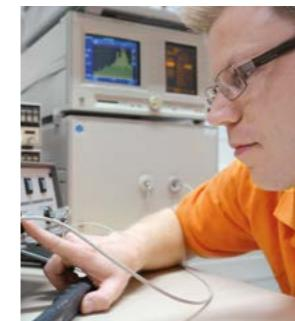
Die Messtechnik der elektromagnetischen Verträglichkeit (EMV) befasst sich mit der Störmessung und Prüfung der Störfestigkeit von Geräten. Hierzu können wir mit unserem breiten Akkreditierungsumfang mit Verfahren nach gängigen Normen (DIN EN 61000-4-x, DIN EN 55016-1-x, CISPR 16-1-x) die wichtigsten EMV-Größen kalibrieren.
