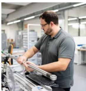
Auf unserer speziell eingerichteten Kalibrieranlage für Drehmoment mit einem Messbereich von 0,01 Nm bis 5.000 Nm verfügt Testo Industrial Services über das Know-how und das Equipment ISO- und DAkkS-akkreditierte Kalibrierungen für Ihre Drehmomentschrauber, -schlüssel, -prüfgeräte, und -sensoren nach normativen Vorgaben durchzuführen.
