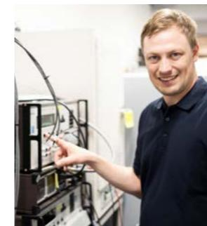
Unser Kalibrierlabor für Elektrik verfügt über eine der kleinsten Messunsicherheiten unter allen DAkkS-akkreditierten Laboren. Widerstandsnormale können beispielsweise mit einer Messunsicherheit ab  $50 \cdot 10^{-9}$  kalibriert werden.
