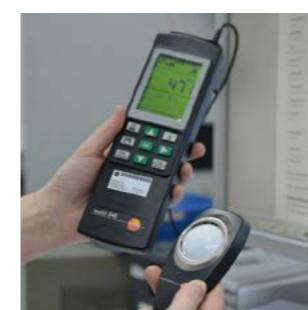
Im Bereich des Arbeitsschutzes spielt die Messung von Lichtstärke eine entscheidende Rolle, denn gute Arbeitsbedingungen stehen an erster Stelle. Hierzu zählt auch die Überprüfung der Lichtverhältnisse am Arbeitsplatz. Daher werden in fast allen Branchen Lichtstärkemessgeräte eingesetzt. Testo Industrial Services hat die Kompetenz Kalibrierungen von Lichtstärkemessgeräten in einem Messbereich von 0 lx bis 10.000 lx durchzuführen.
