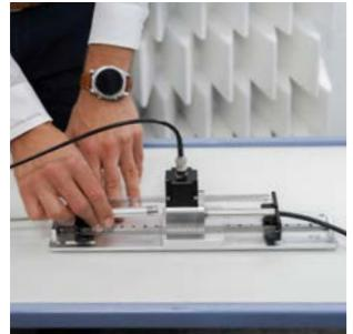
In der Druckkammer von Testo Industrial Services können akustische Messgeräte DAkkS-akkreditiert kalibriert werden. Die Druckkammerkalibrierung ist von 31,5 Hz bis 16 kHz in Terz- bzw. Oktavschritten möglich. Die Kalibrierung von Druckmikrofonen ist nach DIN EN 61094-5 konzipiert und unsere Bewertungen richten sich nach der DIN EN 61094-4. Auch die Kalibrierung akustischer Dosimeter ist möglich; diese sind nach DIN EN 61094-5 konzipiert und unsere Bewertungen richten sich nach der DIN EN 61252.
