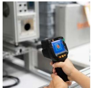
Neben den klassischen Temperaturmessgeräten kommen Messgeräte zur Überprüfung der Oberflächentemperatur zum Einsatz. Zudem werden berührungslose Oberflächentemperaturmessungen bei der Kalibrierung von Wärmebildkameras und Pyrometern vorgenommen. Berührungslose Messgeräte kalibrieren wir in schwarzen Flüssigkeitsstrahlern in einem akkreditierten Bereich von -18 °C bis 350 °C, berührend von -15 °C bis 500 °C.
