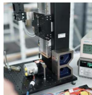
Wir ermitteln an unserer Linearmotor-Achse die Linearität von unterschiedlichsten Wegsensoren nach jeweiligen Herstellerangaben mit einem akkreditierten Messbereich von 1.000 mm. Hierbei werden mit zunehmender Menge an elektronischen Wegsensoren die einzelnen Prüfpositionen vollautomatisch mit hoher Geschwindigkeit angefahren.
