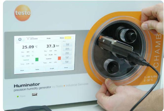
Huminator II est conçu pour réaliser des étalonnages en humidité relative de manière très précis et rapide. Pour l'utilisation en laboratoire, où les temps de mise en route et où la continuité des prestations est primordial, il se distingue par une performance extraordinaire et par une grande fiabilité.
